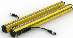
Die Sicherheits-Lichtvorhänge der SEMG-Baureihe sind die ideale Lösung für die Basisaufgaben der Maschinensicherung. So sind die Grundfunktionen Schutzbetrieb, Wiederanlaufsperrung und Schützkontrolle (dynamische Überwachung des Schaltverhaltens der externen Schütze) standardmäßig integriert und können einfach konfiguriert werden. Ohne Überstand reicht das Schutzfeld stets bis zum Gehäuseende.
