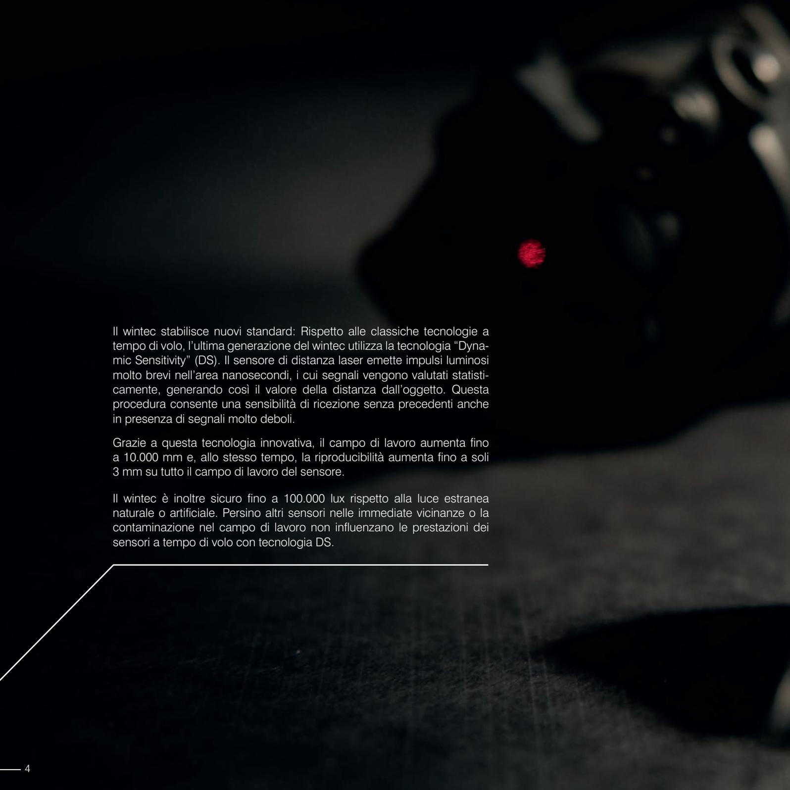
Il wintec stabilisce nuovi standard: Rispetto alle classiche tecnologie a tempo di volo, l'ultima generazione del wintec utilizza la tecnologia "Dynamic Sensitivity" (DS). Il sensore di distanza laser emette impulsi luminosi molto brevi nell'area nanosecondi, i cui segnali vengono valutati statisticamente, generando così il valore della distanza dall'oggetto. Questa procedura consente una sensibilità di ricezione senza precedenti anche in presenza di segnali molto deboli.
