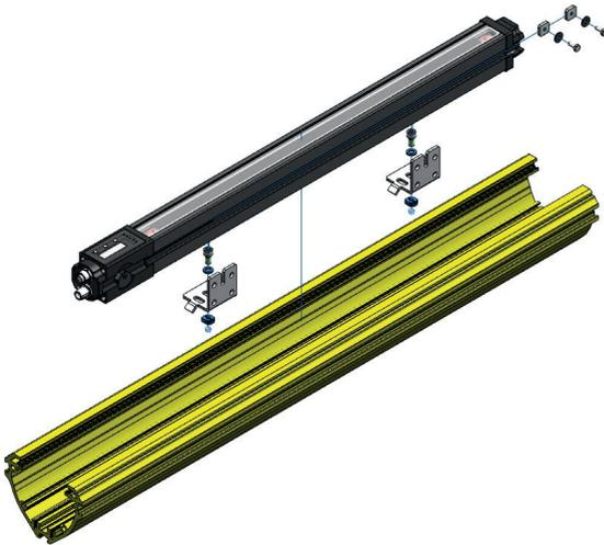
Figure 21: Installation avec ZEFX003
