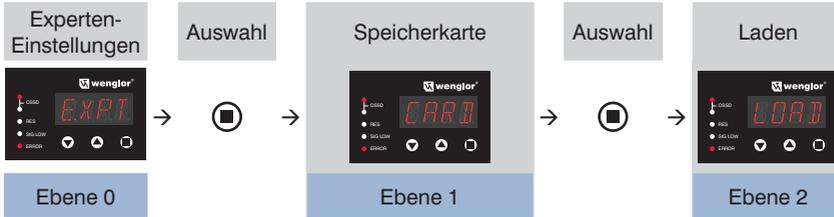
2. Geladene Parametrierung im Sensorspeicher sichern:
