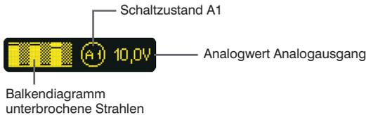
Die eingestellte Funktion der Pins wird im Anzeigemodus symbolisch dargestellt:
