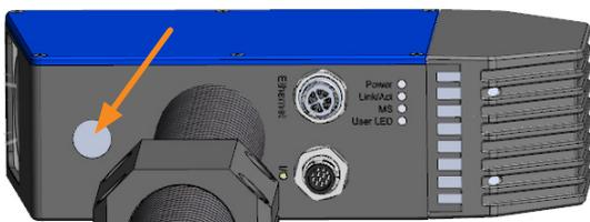
Abb. 3: Tastenposition bei MLBSxxx
