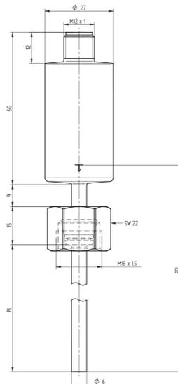
Prozessanschlusslänge PCL bei Schneid-Klemmring = Stablänge PL + 9 mm
