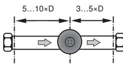
Sensoren in geschlossene Systeme und Steigleitungen einbauen, in nach unten offenen Rohren ist die Erfassung der Strömungsgeschwindigkeit fehlerhaft.
