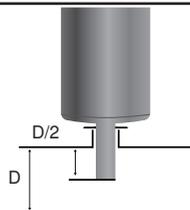
Für die korrekte Erfassung der Strömungsgeschwindigkeit ist ausreichend Abstand zu Querschnittsänderungen und Rohrbögen zu halten. Die angegebenen Abstände sind als Minimalabstände zu verstehen. Je nach Art des Störeinflusses können die angegebenen Werte variieren.
