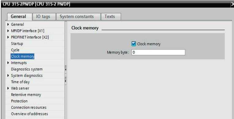
In der Hardwarekonfiguration kann über einen Doppelklick auf die CPU ein Menüfenster geöffnet werden. In diesem Fenster können unter anderem Einstellungen wie das Festlegen des Taktmerkerbytes oder die An- und Abwahl der Taktmerker realisiert werden.
