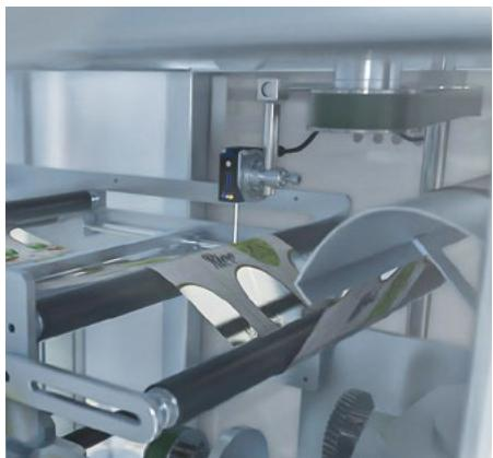
▼ **Controle de extremidade do produto** por meio de marcas visuais para, por exemplo, providenciar a troca do rolo de material de película a tempo.
