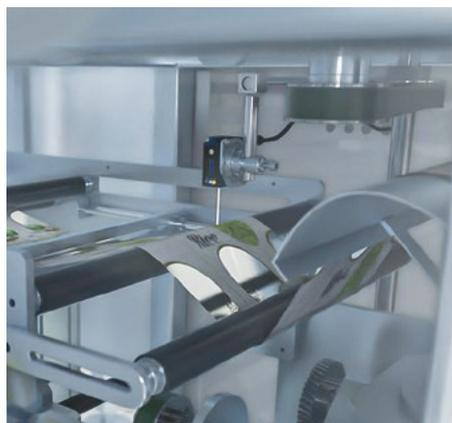
▼ **Controllo del colore degli oggetti** per il controllo qualità in base alle caratteristiche estetiche.
