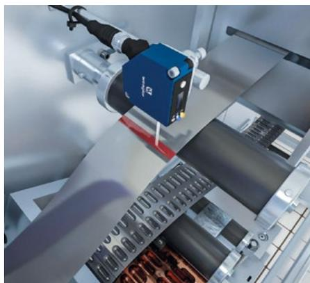
▼ **Controllo dell'estremità del materiale** tramite contrassegni visivi, ad esempio per consentire una sostituzione tempestiva del rotolo di materiale della pellicola.
