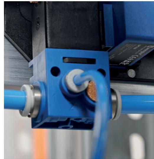
Avec une consommation de courant inférieure à 16 mA, les capteurs reflex de wenglor font partie du nec plus ultra en terme d'économie d'énergie. Grâce à l'EcoMode intégré, la puissance absorbée par les électrovannes est réduite de 75 % et vous économisez plus de courant pendant la durée de fonctionnement.
