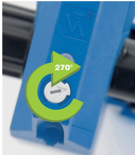
Grâce au nouveau potentiomètre gradué à 270°, il est possible de régler les distances de commutation de manière rapide, continue et simple. Chaque position du potentiomètre peut ainsi être attribuée du premier coup d'œil à une certaine distance de commutation – même lorsque le système ne fonctionne pas. Cette possibilité de réglage offre un gain de temps considérable, notamment avant la première mise en service.
