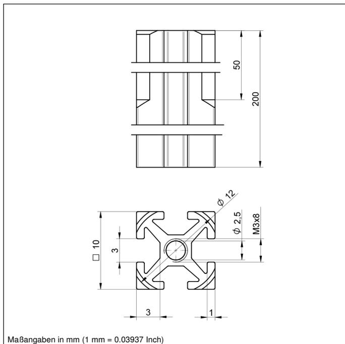
\* Einseitig, mit einer Länge von 50 mm abgedreht. Der Übergang in 10 × 10 mm Vierkant ist mit einer Fase von 45° versehen.
