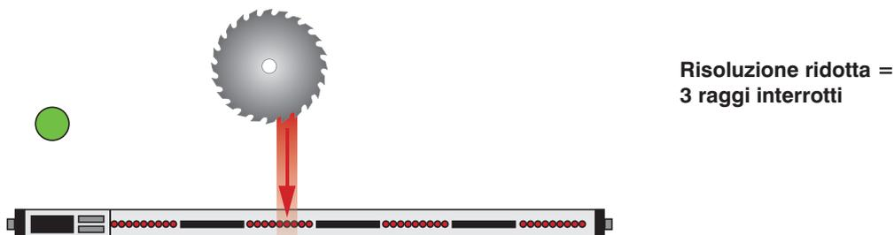
Se un oggetto più grande della risoluzione passa attraverso la barriera le uscite di sicurezza arrestano la macchina.
