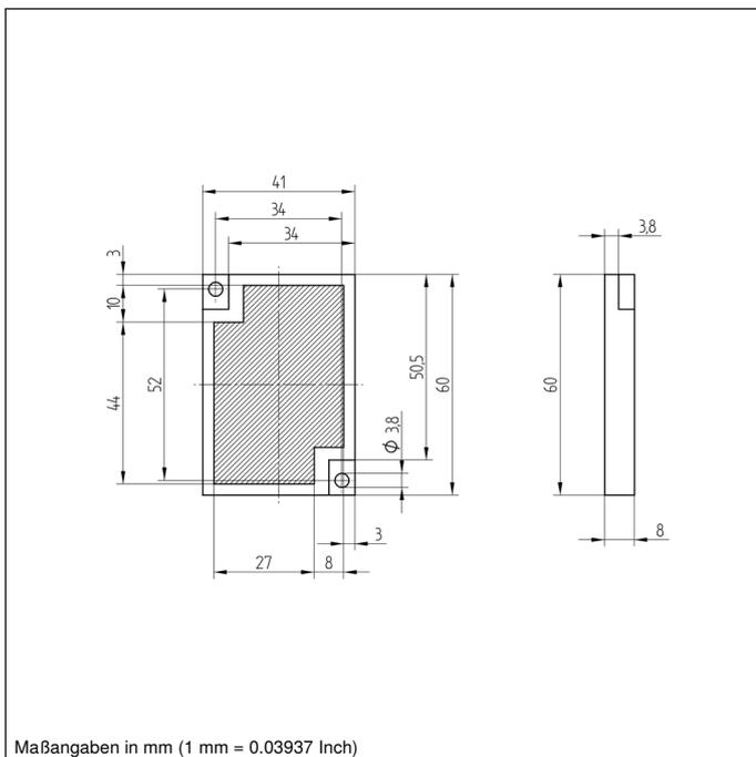
Der Reflektor ist nicht mehr mit einer Antibeschlagschicht ausgestattet. Bei Bedarf einer Antibeschlagschicht kann Reflektor Z90R013 eingesetzt werden.
