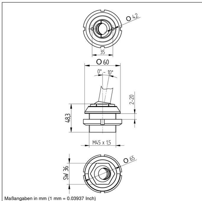
InoxSens ist die Hygieneserie von wenglor. Zu diesem Komplettsystem, das sich nahtlos in die Maschine integriert, gehört neben zahlreichen weiteren Komponenten auch die InoxSens-Befestigungskonsole. Die InoxSens-Sensoren und -Befestigungsrohre können mit der Befestigungskonsole durch die Anlagenwand hindurchgeführt und dort spaltfrei befestigt werden. Die Sensoren können selbst an schrägen Flächen montiert werden und sind dank Winkelausgleich bis 10° schnell und einfach justiert.
