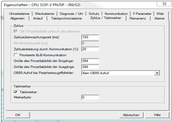
In der Hardwarekonfiguration kann über einen Doppelclick auf die CPU ein Menüfenster geöffnet werden. In diesem Fenster können unter anderem Einstellungen wie das Festlegen des Taktmerkerbytes oder die An- und Abwahl der Taktmerker realisiert werden.
