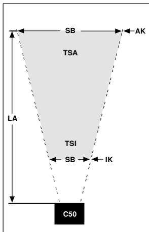
AK = Angolo esterno    IK = Angolo interno    LA = Campo di lettura    SB = Ampiezza di lettura    TSA = Profondità di campo AK    TSI = Profondità di campo IK
