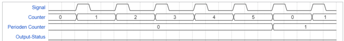
Abb. 1: Only counts Funktion – Aufwärtszählen
