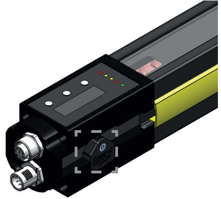
Abbildung 18: Zugang zur Speicherkarte am BWS-Empfänger
