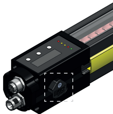
Figure 29: Accesso alla scheda di memoria del ricevitore ESPE
