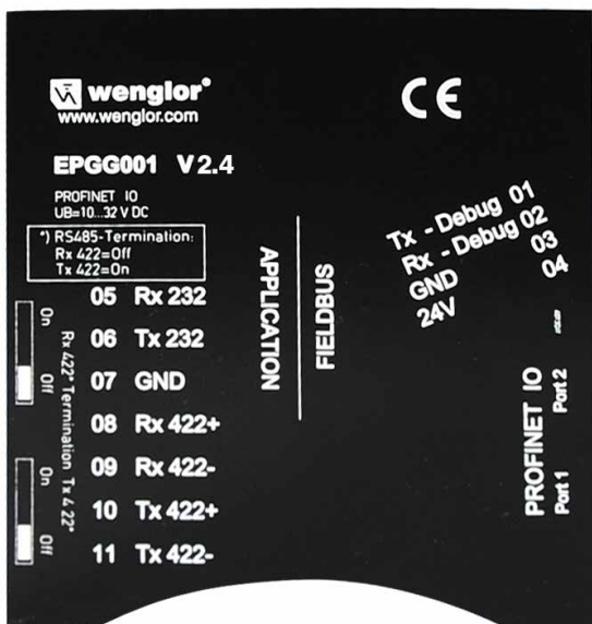
Bild 1: Anschlussbeschriftung und Terminierung
