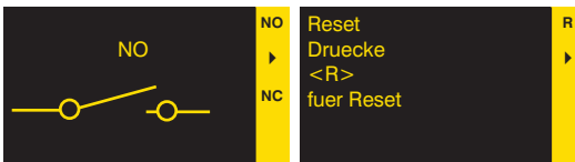
Abb. 2: Öffner / Schließer einstellen
