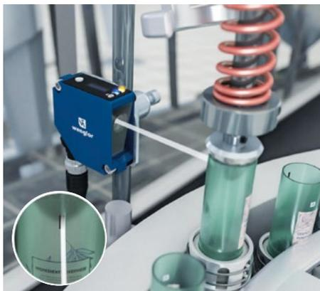
► **Reconhecimento de marcas de impressão** para controlar vários processos, como o alinhamento e o posicionamento de objetos ou processos de corte, soldagem e colagem.
