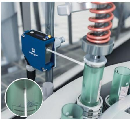
► **Reconnaissance des marques d'impression** pour contrôler divers processus tels que l'alignement et le positionnement d'objets ou les processus de découpe, de soudage et de collage.
