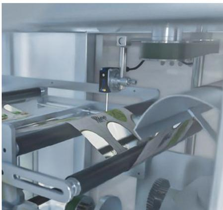
▼ **Contrôle de l'extrémité du matériau** à l'aide de repères visuels, par exemple pour déclencher un changement de rouleau de film au bon moment.
