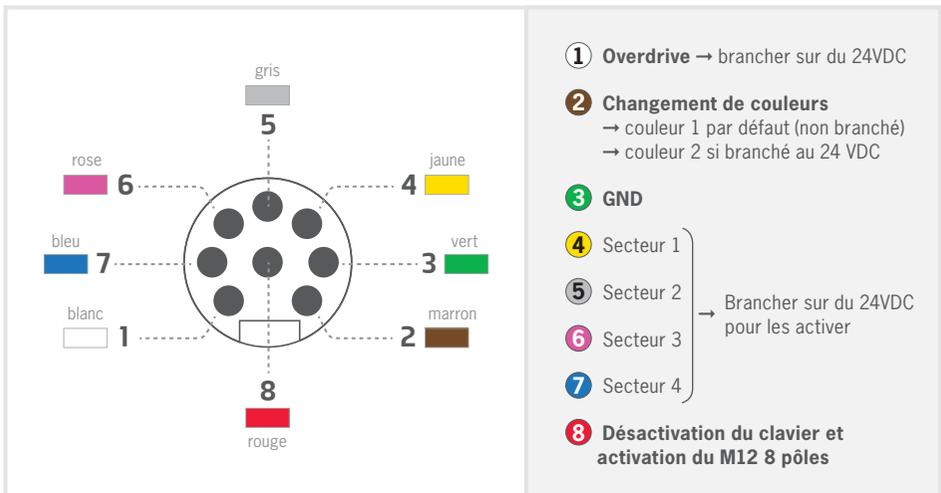
CONTRÔLE À DISTANCE VIA LE SIGNAL PNP : 0-4V=OFF et 5-24V=ON.
