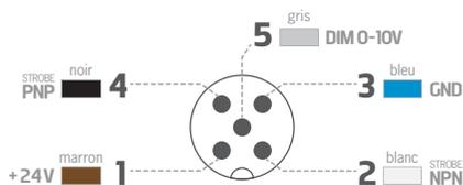
Le connecteur **M12 5 points mâle** est **COMPATIBLE** avec les connecteurs femelles 4 pôles. Dans ce cas, la fonction Dimming n'est cependant pas disponible.
