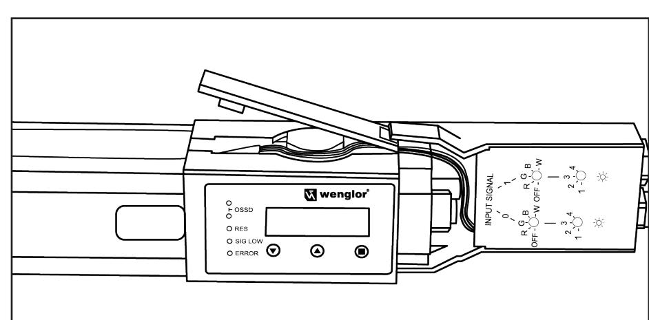
**6. LED-Signalstreifen anbringen. Beidseitige Montage möglich (Sender)**
