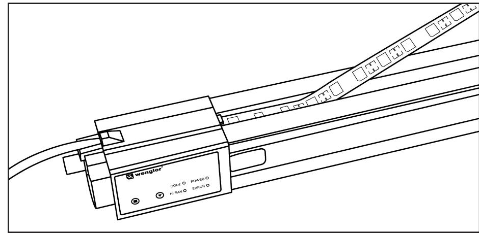
**9. LED-Signalstreifen (Sender) mit Verbindungskabel anschließen**
