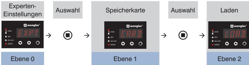
2. Geladene Parametrierung im Sensorspeicher sichern:
