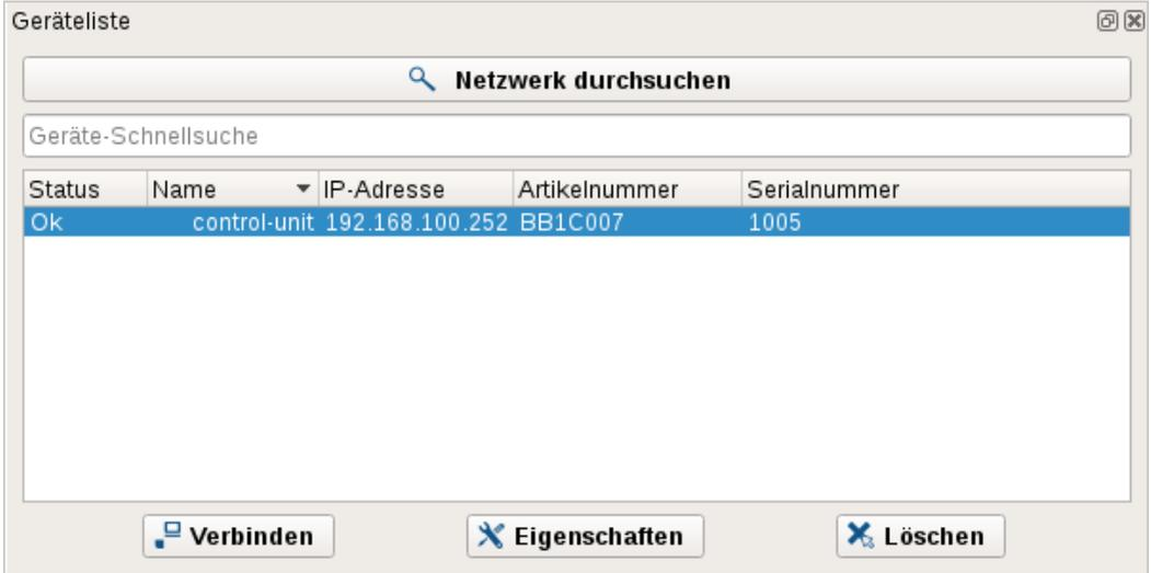
Mit einem Doppelklick auf die Control Unit oder nach Auswahl der Control Unit auf „Verbinden“ klicken, um alle an die Control Unit angeschlossenen Geräte anzuzeigen. Bei der VisionApp 360 „Verwaltet durch Control Unit“ auswählen.
