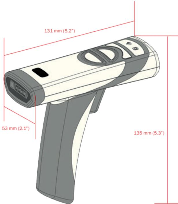
Abbildung 12 Abmessungen CSLH003-Lesegerät
