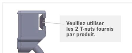
L'éclairage doit être mis en place non raccordé électriquement et donc hors tension. Veuillez utiliser des vis M4 et la rainure située à l'arrière. Il est également possible d'utiliser les filetages M2. Montez le boîtier d'alimentation à l'aide des filetages M4 intégrés.
