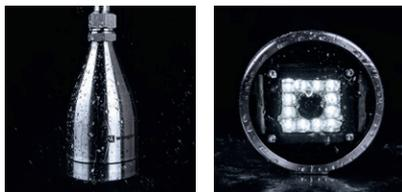
La **carcasa de protección** para weQube con autofocus de la línea de productos InoxSens de wenglor posibilita la inserción en áreas industriales sensibles a la higiene. La carcasa soldada con láser de acero V4A libre de corrosión cumple con la alta demanda del **índice de protección ambiental IP69K**.
